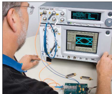
Bild 1: Das BERTScope S und die flexible Takt-rückgewinnung DCRJ (mit optischem Referenzempfänger) für Compliance Test von 10 Gbit/s XFP Transceivern.
